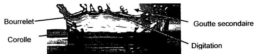
Figure 1. Photographie de l'impaction d'une goutte d'eau sur un film liquide ( d_g = 3,9 mm, S_f = 0,3 et V_g = 3 m.s -1 ), IRSN-LPMA.
